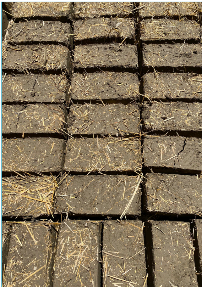
Mattoni "sai" appena realizzati (2023).
